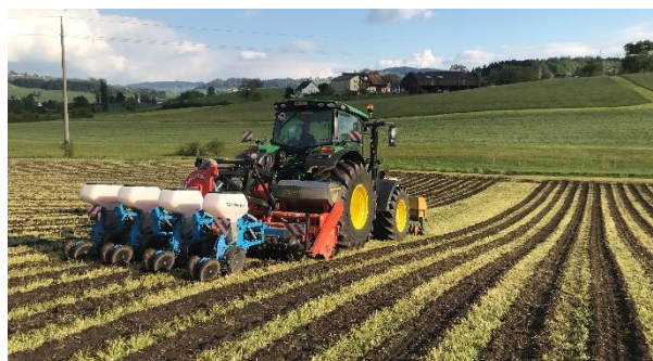
neu: extra breite Bereifung dem Boden zuliebe
